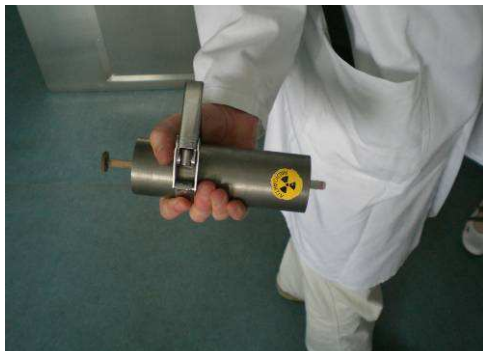
Abb. 4 Spritze umhüllt mit einer Wolframlegierung, da sich in dieser unmittelbar hergestellter Tracer befindet, welcher radioaktiv ist.
