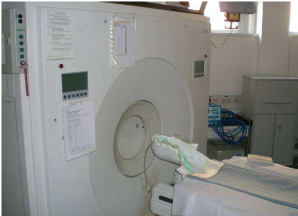
Abb.1 Positronen-Emissions-Tomograph zur Diagnostik physiologischer und biochemischer Merkmale innerhalb eines lebenden (in vivo) Organismus.
