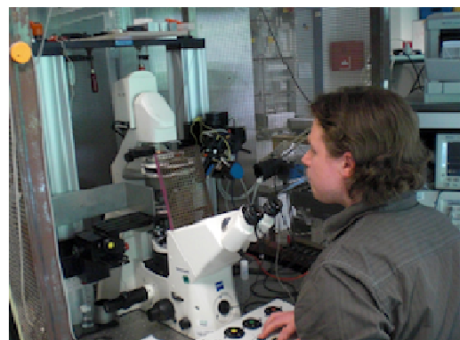
Abb.4 Das Mikroskop und alle benötigten Gerätschaften zur Durchführung der Patch-Clamp Methode
